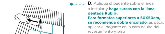
D. Aplique el pegante sobre el área a instalar y haga surcos con la llana dentada Rubi®,. Para formatos superiores a 50X50cm, se recomienda doble encolado, es decir, aplicar el pegante en la cara oculta del revestimiento y piso.
