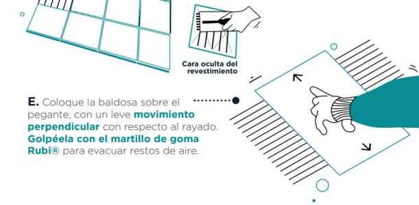
E. Coloque la baldosa sobre el pegante, con un leve movimiento perpendicular con respecto al rayado. Golpéea con el martillo de goma Rubi® para evacuar restos de aire.
